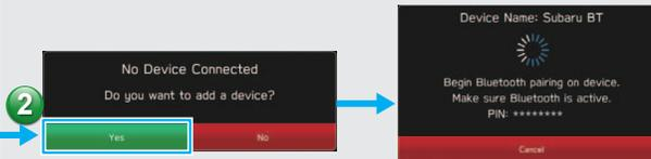
Active la función Bluetooth del teléfono/dispositivo Bluetooth y seleccione “Subaru BT”. Si desea registrar un dispositivo compatible con NFC\*, manténgalo sobre el logo NFC del sistema audiovisual hasta que se establezca la conexión.
