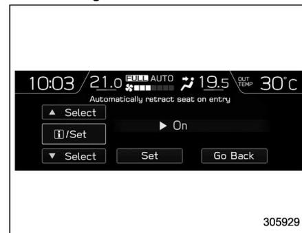
2. Seleccione “On” u “Off” con los interruptores de control para activar o desactivar la función de entrada/salida automática.
