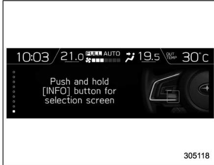
Cuando se pulsa el botón INFO del volante y se mantiene pulsado en esta pantalla, se puede ver la pantalla de configuración.
