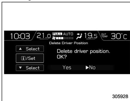
2. Seleccione “Yes (Sí)” para eliminar la posición del conductor. Seleccione “No” para volver a la pantalla anterior.
