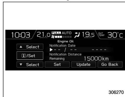
2. Ajuste la fecha y la distancia para el recordatorio con los interruptores de control.
